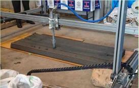
特注のセメントを機械で練り、青いホースの部分をセメントが流れていきます。 造形物は、セメントの硬さや形成の速度を変えることで硬化時間を調整し、高さの あるものも施工可能になります。
