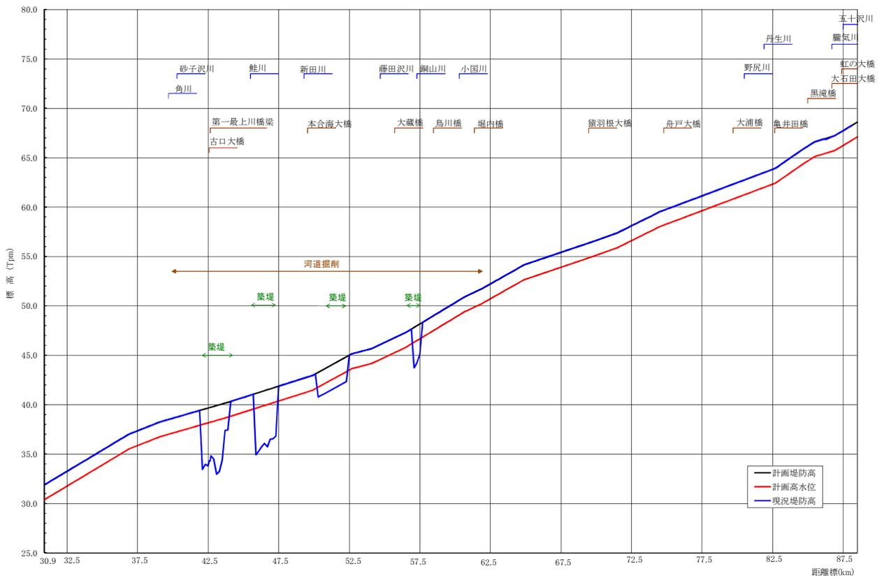
図 5-7 堤防縦断図 最上川中流（右岸）
