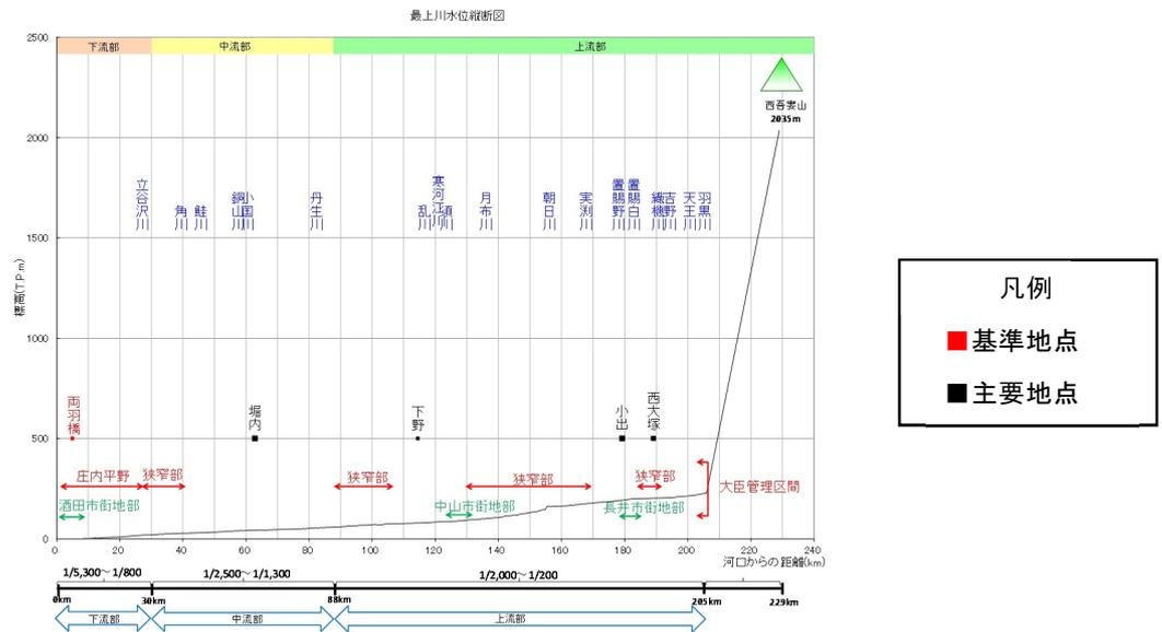
図 3-2 最上川本川 河床高縦断面図
