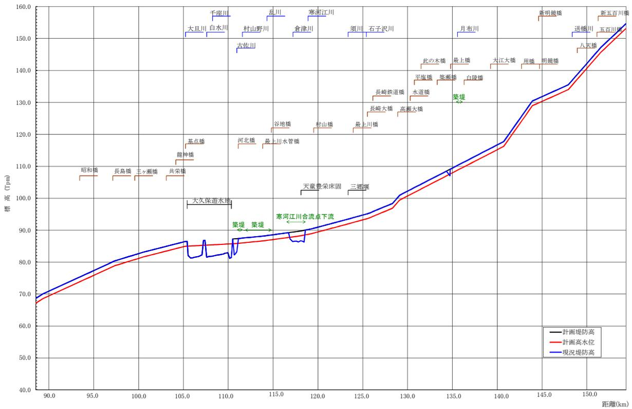
図 5-8 堤防縦断図 最上川上流（左岸①）
