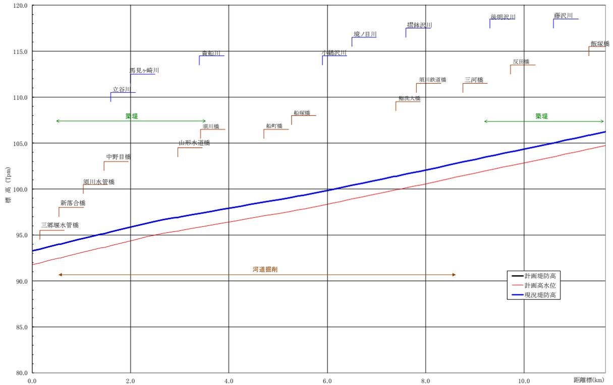
図 5-14 堤防縦断図 須川（左岸）
