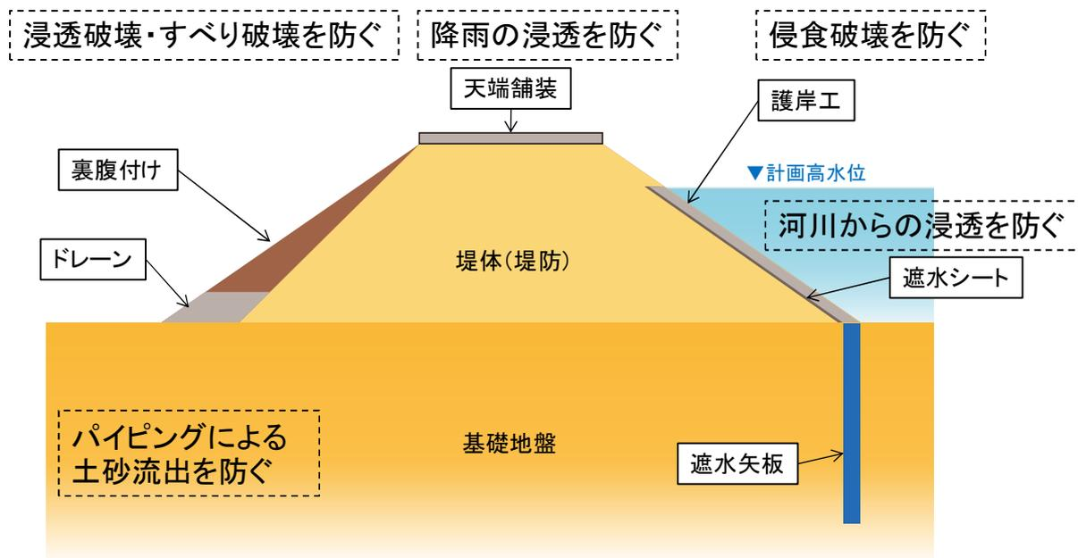
図 5-19 堤防の質的整備断面イメージ
