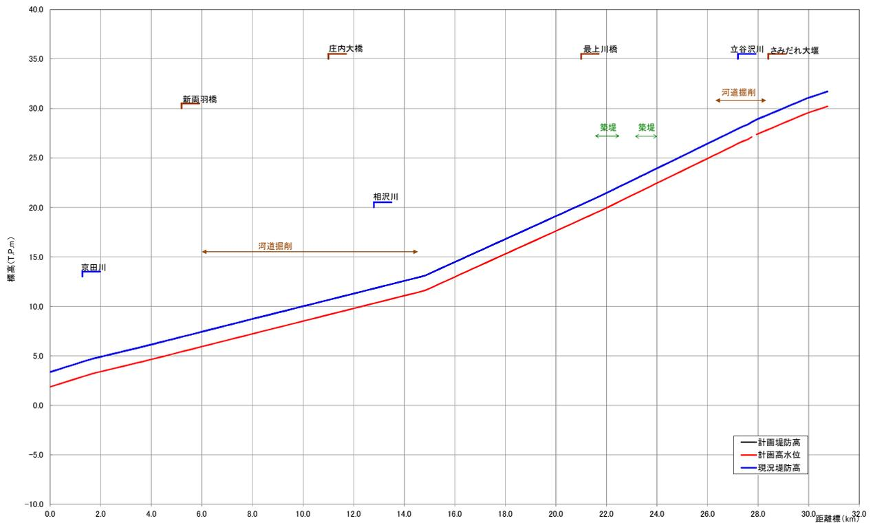
図 5-5 堤防縦断図 最上川下流（右岸）
