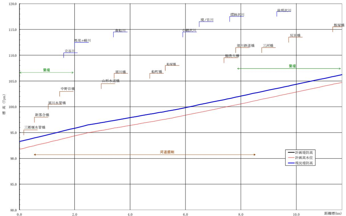
図 5-15 堤防縦断図 須川（右岸）
