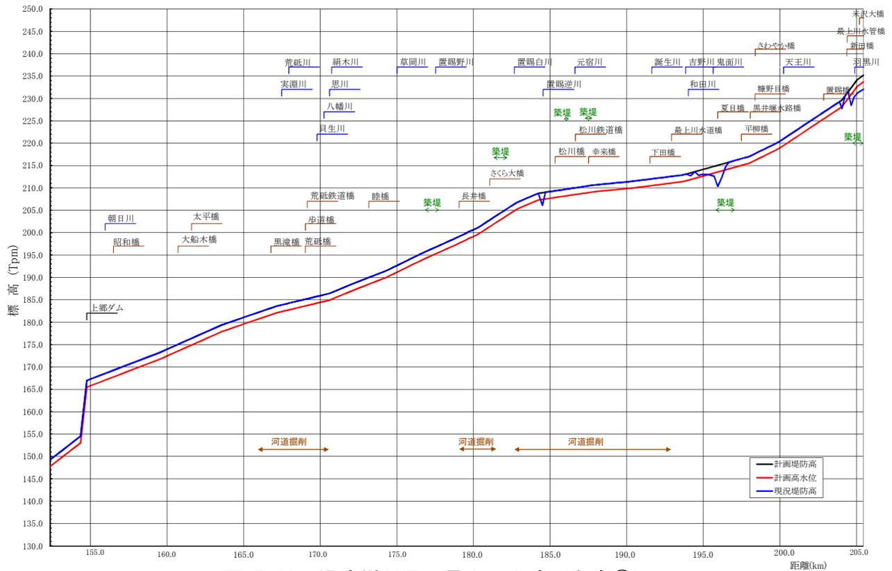
図 5-11 堤防縦断面図 最上川上流（右岸②）
