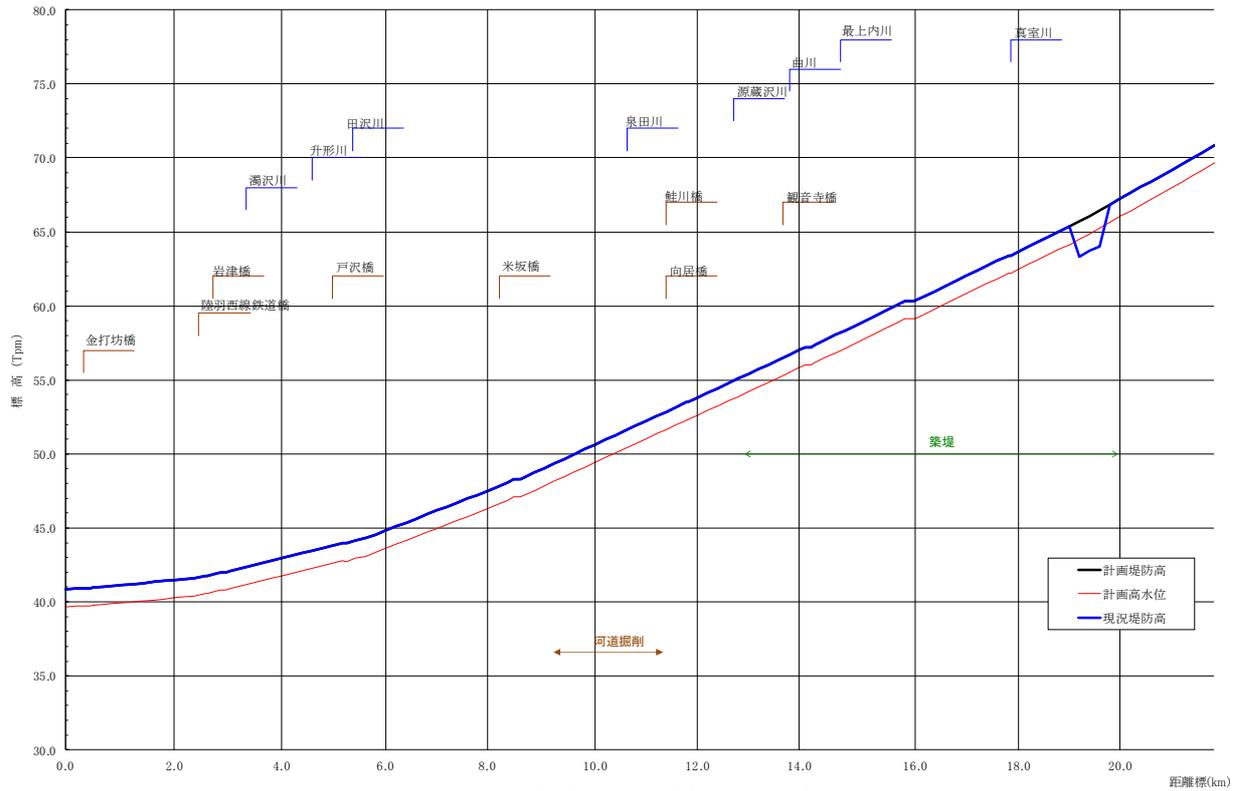
図 5-12 堤防縦断面図 鮭川（左岸）
