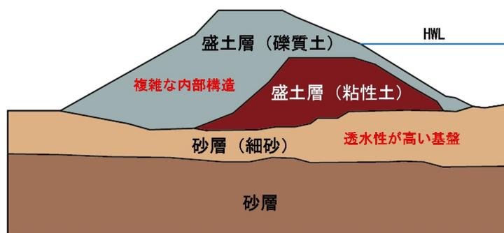
図 3-6 堤防及び基礎地盤の土質イメージ
