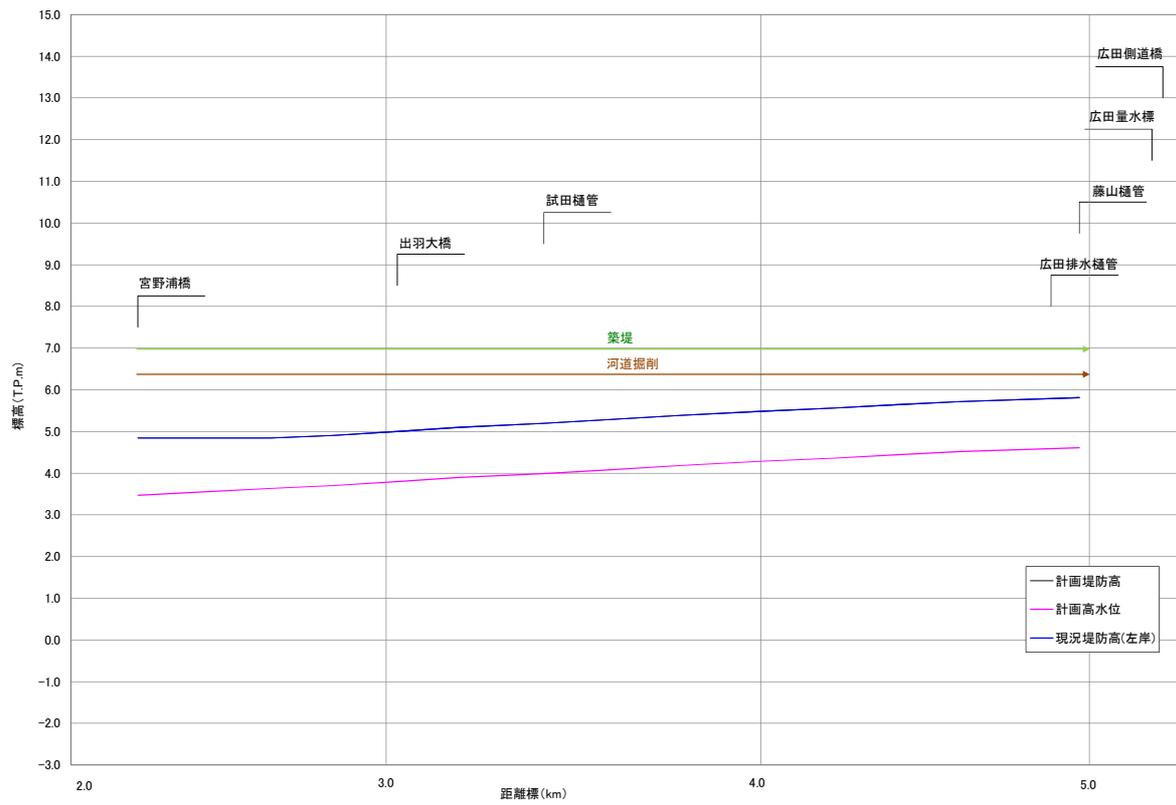
図 5-16 堤防縦断図 京田川（左岸）
