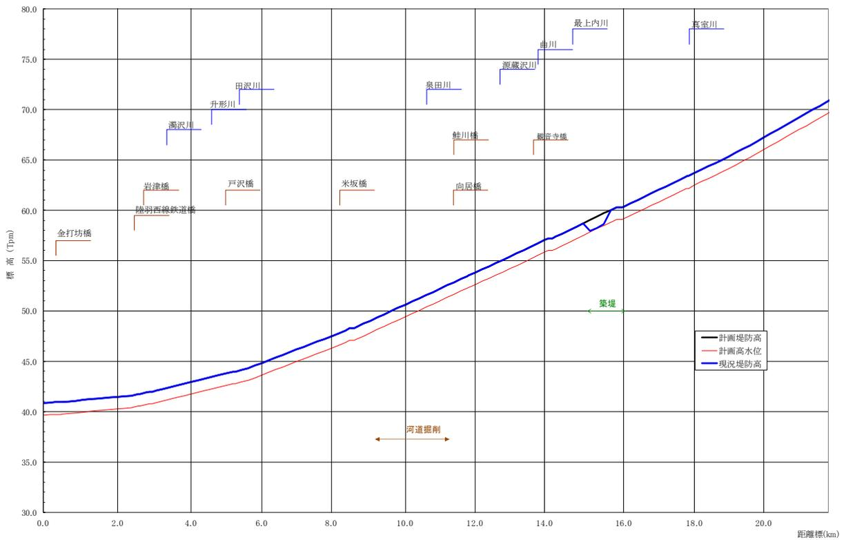
図 5-13 堤防縦断面図 鮭川（右岸）
