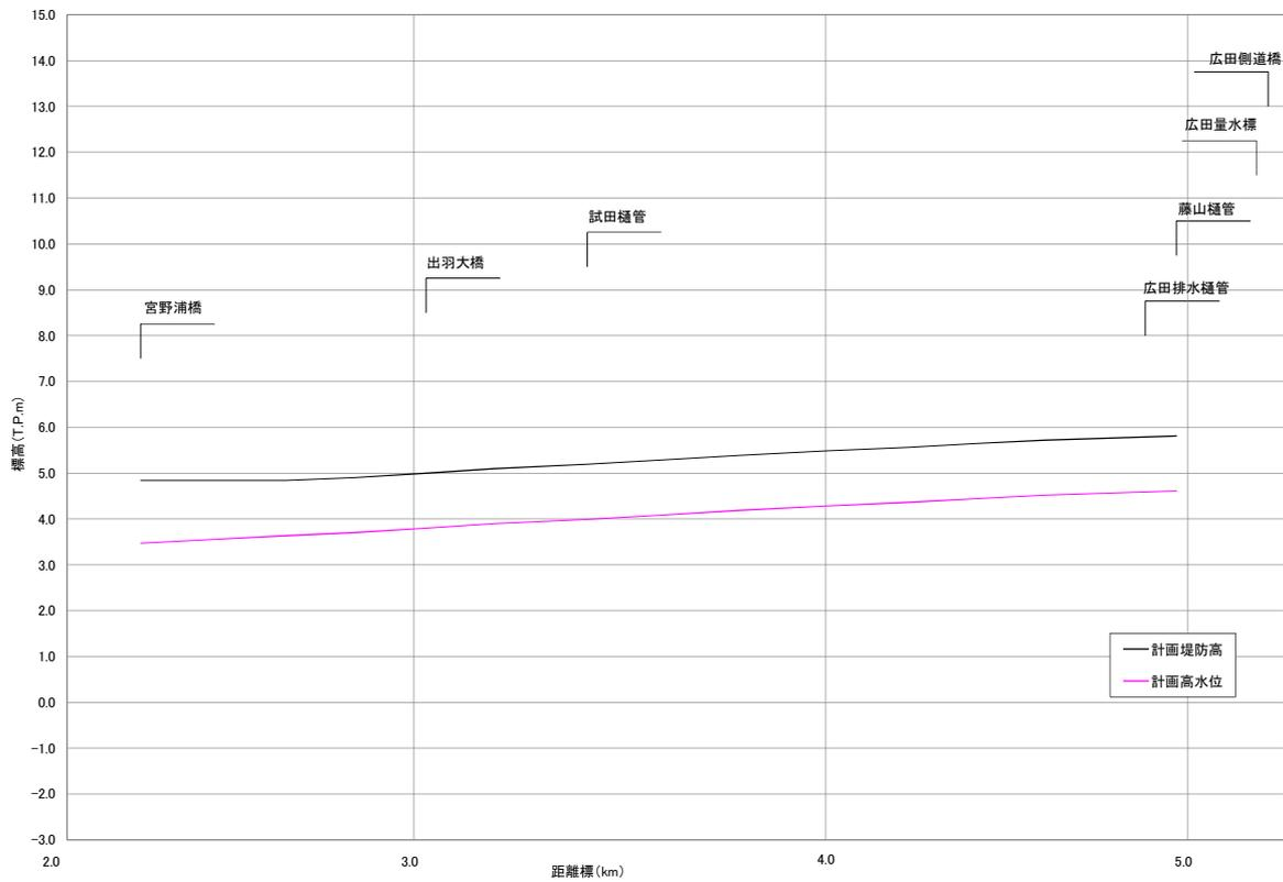
図 5-17 堤防縦断図 京田川（右岸）
