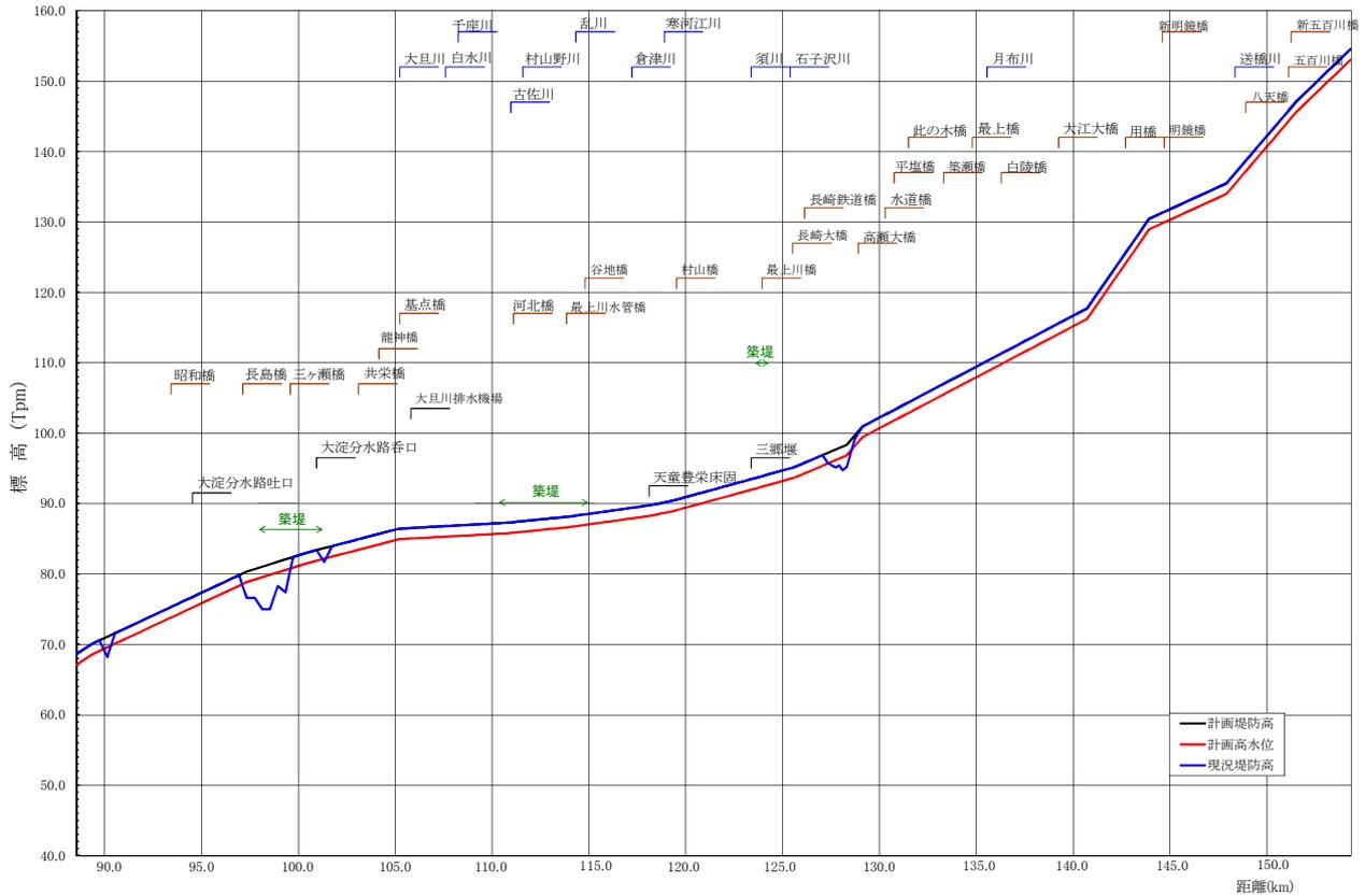
図 5-10 堤防縦断面図 最上川上流（右岸①）
