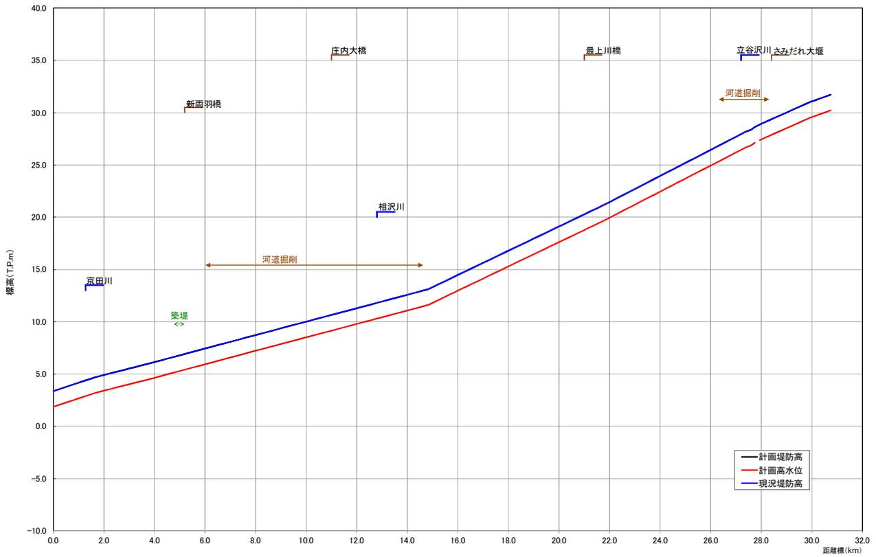
図 5-4 堤防縦断図 最上川下流（左岸）
