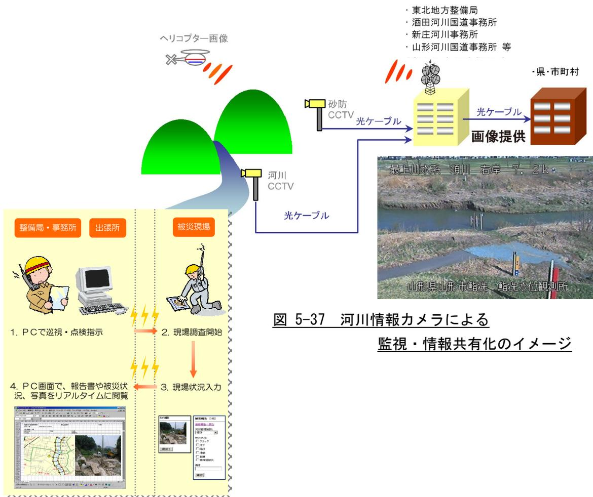
図 5-37 河川情報カメラによる監視・情報共有化のイメージ
