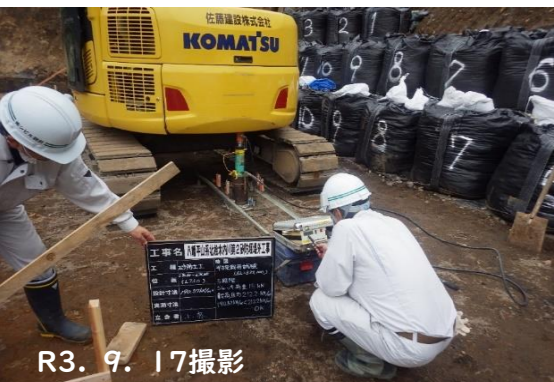
試験後載荷場所 (約1cm沈下3cm沈下でNG)
