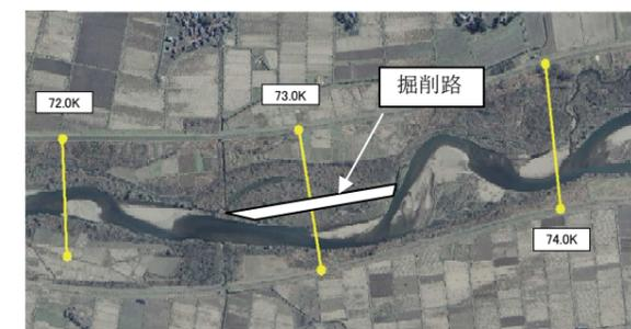
図 5.3.2 掘削路の平面イメージ
