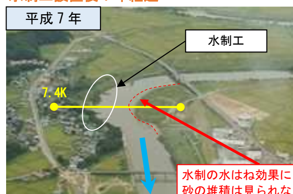
図 4.3.18 水制工設置事例(子吉川)
