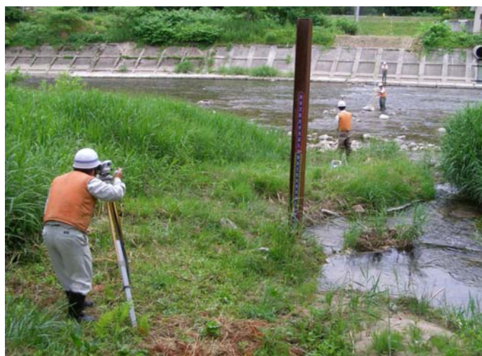
河川横断測量の様子
