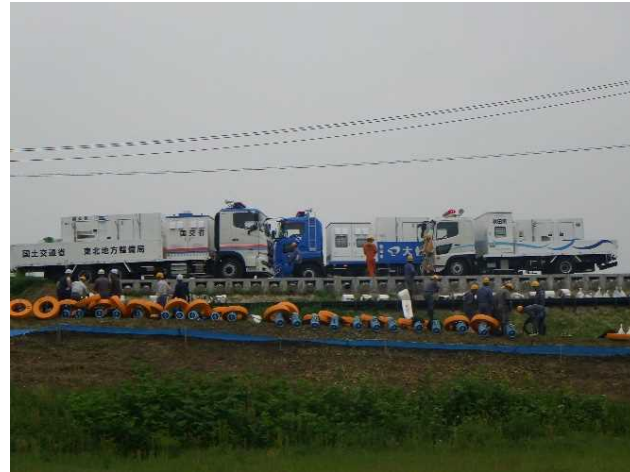
国土交通省・秋田県・大仙市による排水ポンプ車設置訓練状況
