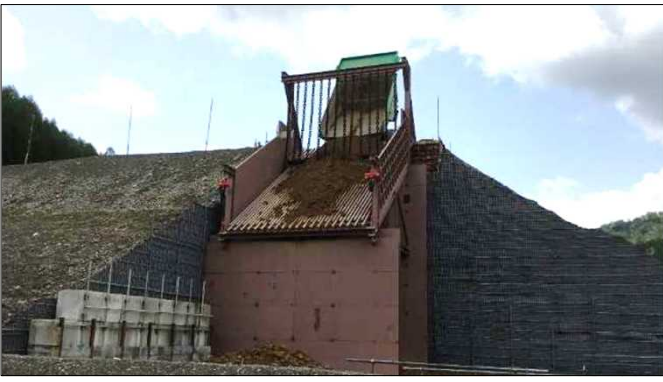
簡易ふるい設備 (バーから扁平材がすり抜ける)
