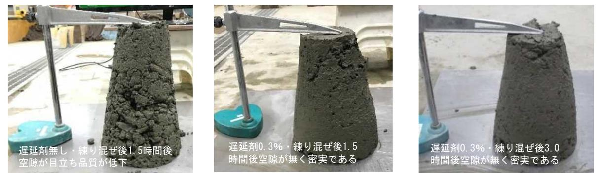
CSG確認試験（実機）（超遅延剤3.0%添加時の効果比較）
