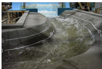
水理模型実験 実施状況 (下流河道)
