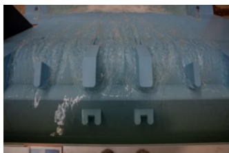
水理模型実験 実施状況 (越流部)
