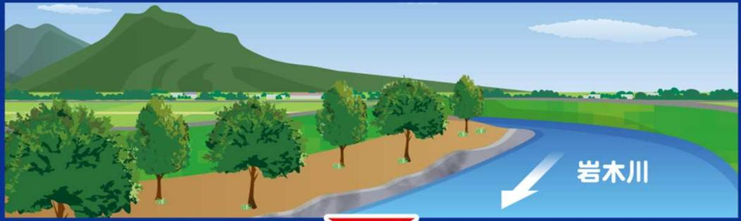
**施工後** 河川区域の土砂を掘削し川の幅を広げ、川の流れを良くし洪水被害を防ぎます
