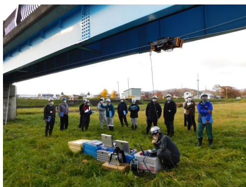
写真6-3 橋梁点検技術講習会状況 (ワイヤ吊下式目視点検ロボット)
