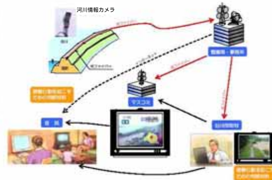
図 5.18 洪水情報共有システム構成図
