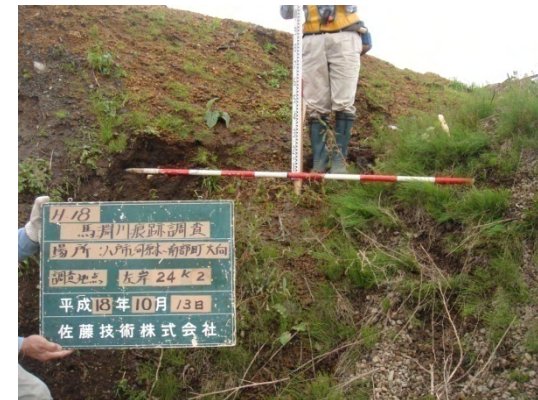
洪水痕跡調査の状況 (H18. 10洪水)
