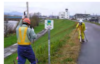
縦断測量の観測の様子
