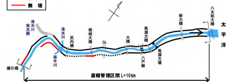
馬淵川の堤防整備の割合(左), 堤防整備状況(右)(平成20年3月31日時点)
