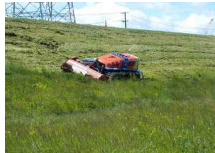
堤防除草作業の無人化
