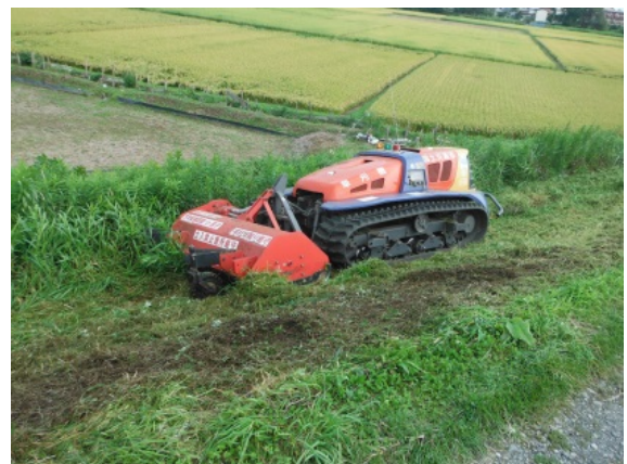
堤防除草作業の無人化
