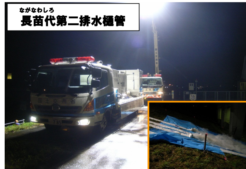
【排水ポンプ車による排水状況】
