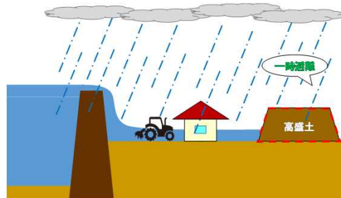
空地への高盛土の設備
