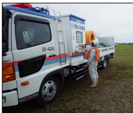
排水ポンプ車 設置訓練状況
