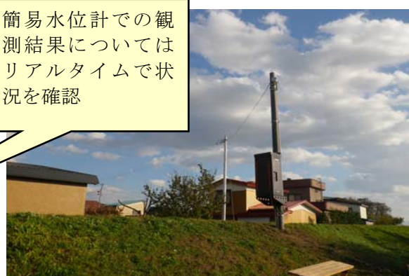
簡易水位計設置状況（イメージ写真）
