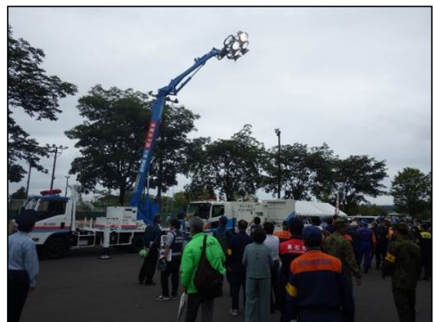
照明車の設置状況
