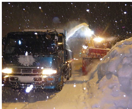
運搬排雪状況(青森市内 国道4号)
