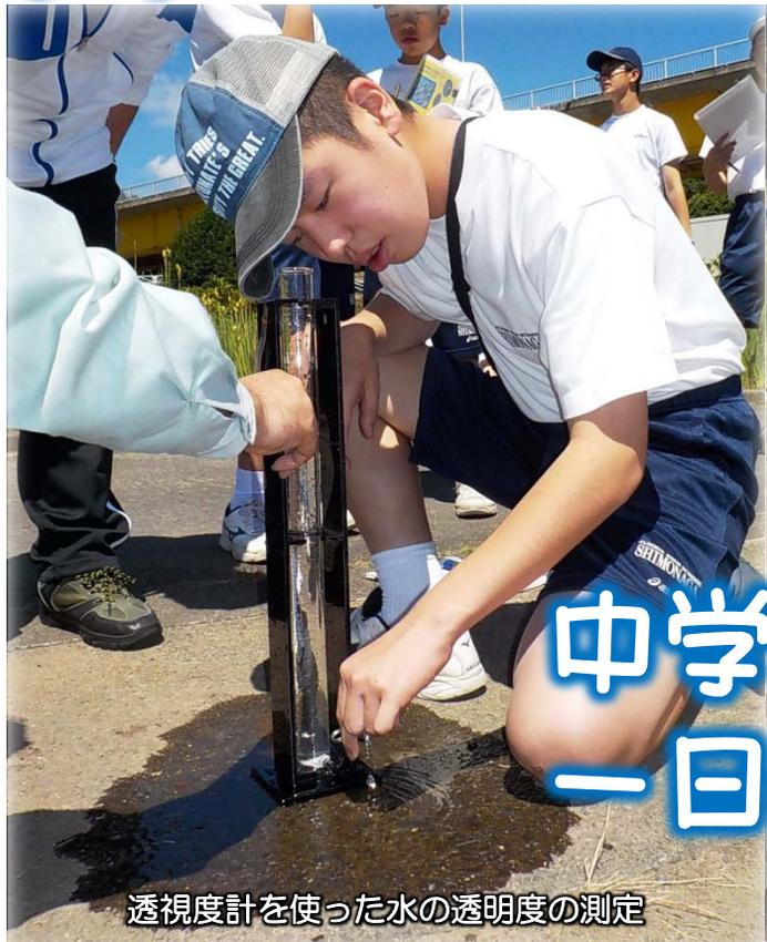
透視度計を使った水の透明度の測定
