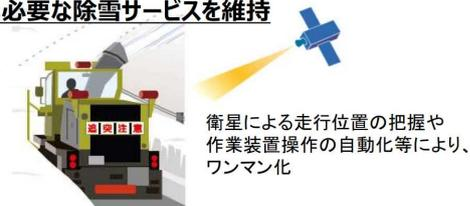
衛星による走行位置の把握や作業装置操作の自動化等により、ワンマン化
