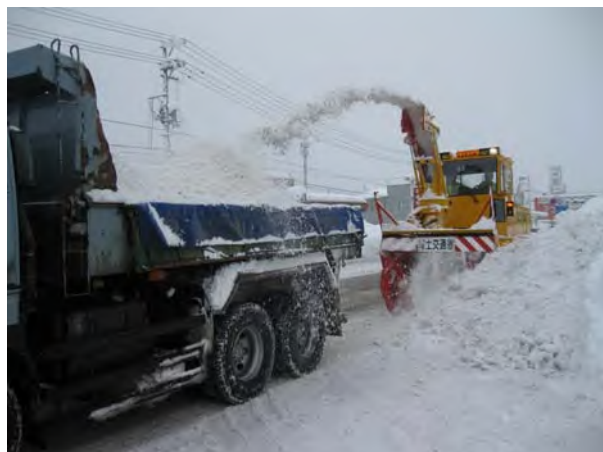
▲運搬排雪の状況
