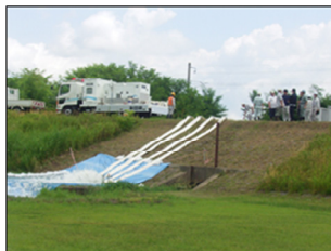
排水ポンプ車訓練状況
