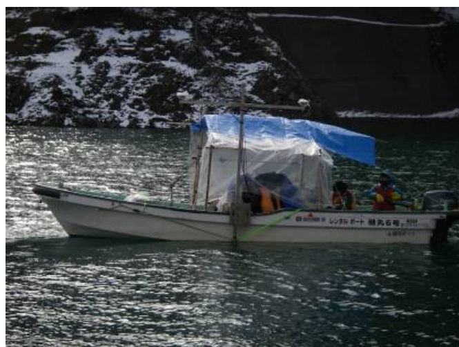
ダムの堆砂測量の様子
