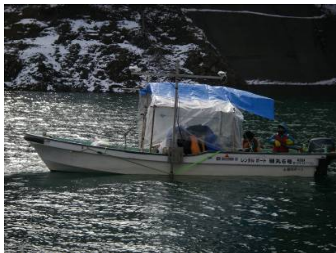
ダムの堆砂測量の様子
