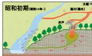
昭和初期の対策工【地下溶透法】
