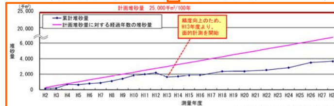
図 3-12 玉川ダムの堆砂状況
