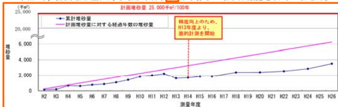
図 3-12 玉川ダムの堆砂状況
