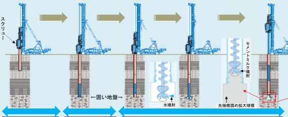
①鋼管内の土を スクリューで掘り ながら、杭を地中 に押し込みます。 ②固い地盤に杭 を到達させます。 ③スクリューを回転させながら高圧水を噴射し、固い地盤を掘ったあとセメントミルクを噴射しながら、スクリューを引き抜きます。
