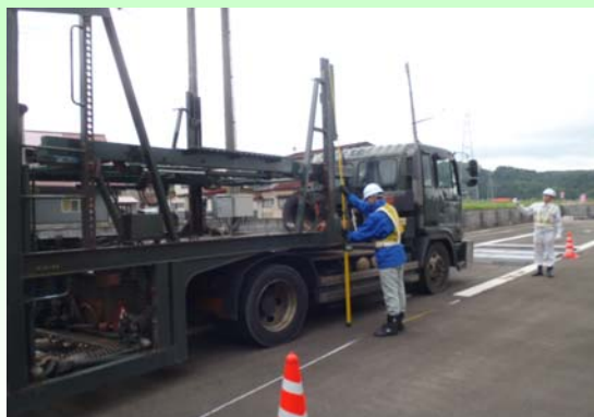
車両の幅・長さ・高さを測定
