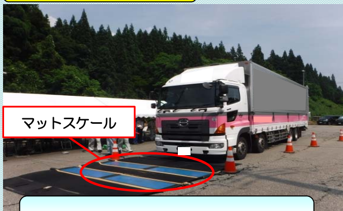
①マットスケールに車体を乗せ総重量を測定
