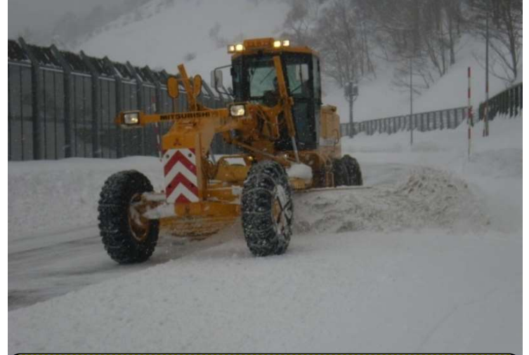
除雪グレーダ 押し潰されて固くなった道路の雪を 削り取ります
