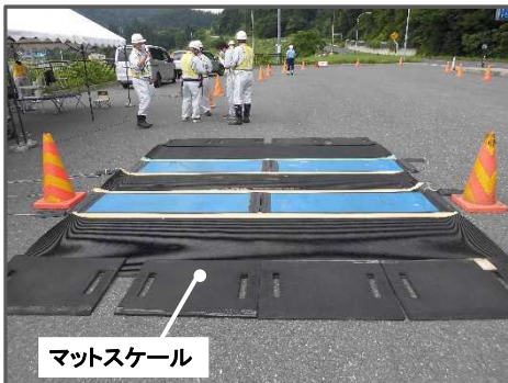
マットスケールに車体を乗せ 総重量を測定
