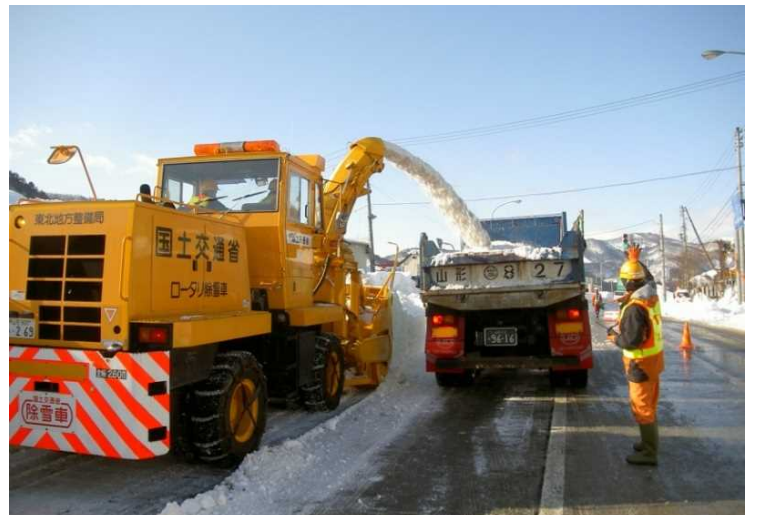
ロータリ除雪車&ダンプトラック 除雪で路肩にたまった雪を運び出し、道路の幅を確保します。
