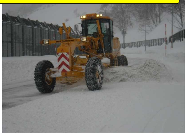
除雪グレーダ 押し潰されて固くなった道路の雪を削りとって平らにします。
