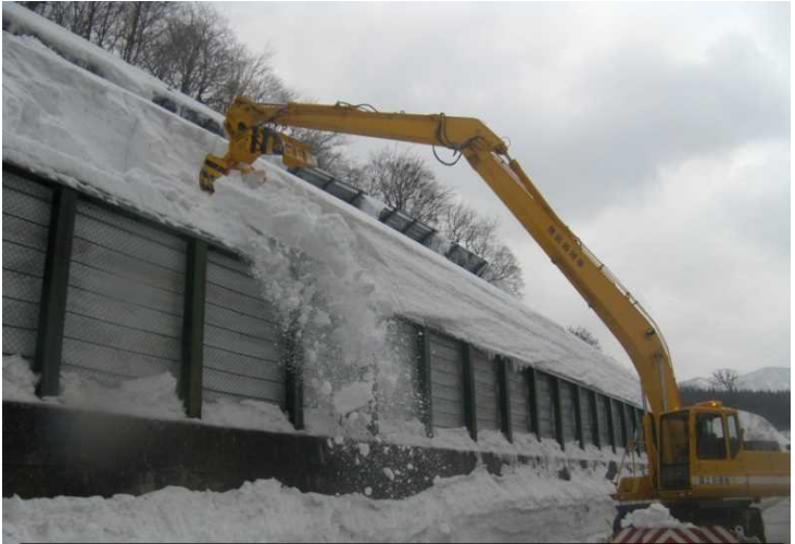
雪庇(せっぴ)処理車 高い位置に張り出した雪(雪庇)などをつかんで、崩落する前に落とします。
