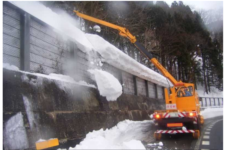
除雪トラック 除雪トラックについている装置で雪庇を処理します。
