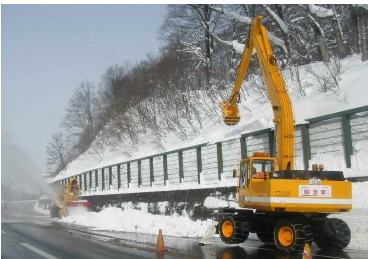
ロータリ除雪車&雪庇(せっぴ)処理車 雪庇処理車で高い位置の張り出した雪を落としてロータリ除雪車で遠くへ飛ばす作業をしています。
