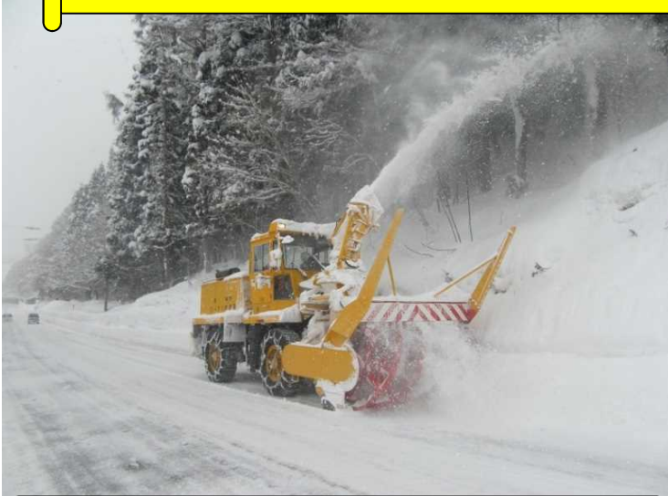
ロータリ除雪車 路肩にたまった雪を遠くへ飛ばして車道を広げます。
