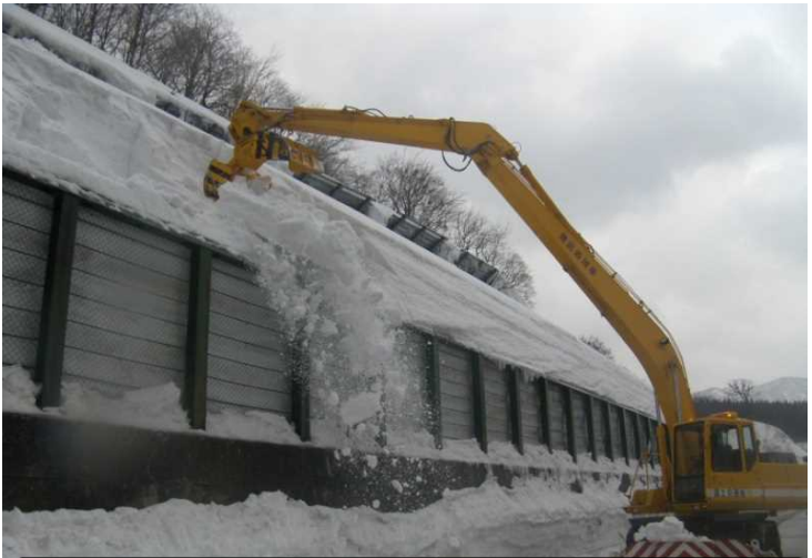
雪庇(せっぴ)処理車 高い位置に張り出した雪(雪庇)などをつかんで、崩落する前に落とします。
