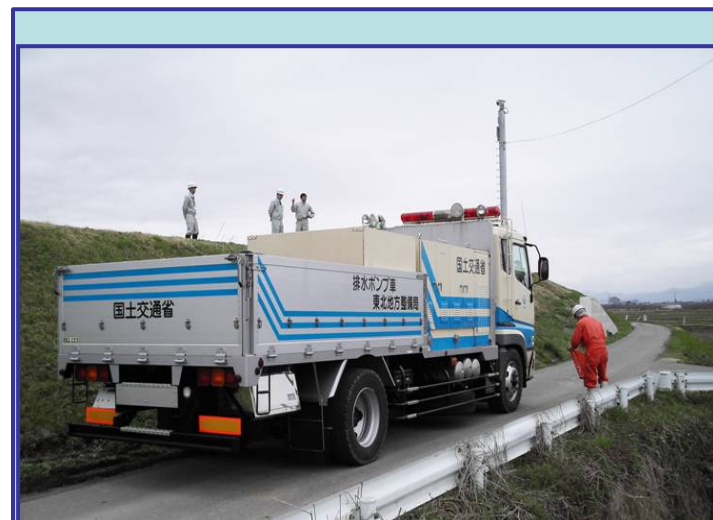
訓練に使用した排水ポンプ車 (60m 3 /min水中モータ式)
