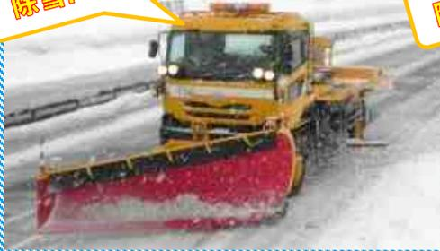
トラックの最前方に、大きな刃の付いた装置（フラウ）で雪を片側に寄せます。
