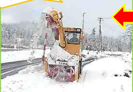
ロータリ除雪車の小型版で1人乗りです。歩道の幅により1m幅対応と1.5m幅対応の除雪車を使い分けています。
