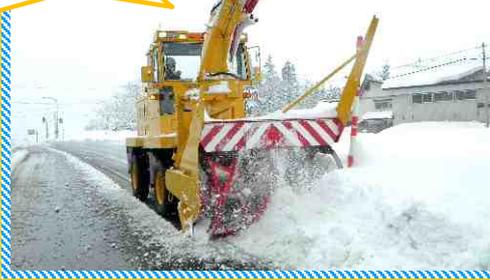
前についているうず巻きのオーガを高速回転させ、雪を砕いて掻き込み、道路脇にたまった雪を飛ばしたり、ダンフに積み込みして、道幅を広くします。
