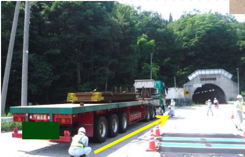
車体の長さを測定
