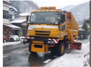
▲運搬排雪車1台
