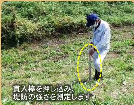
貫入棒を押し込み、堤防の強さを測定します
