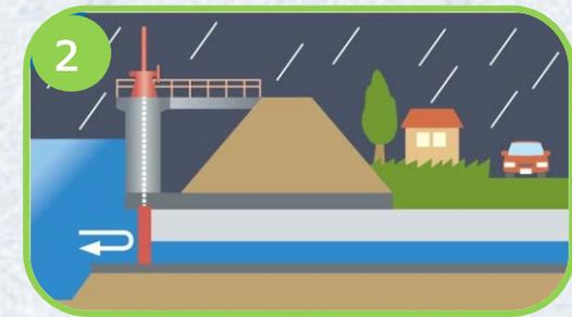
2 洪水で河川の水位が上昇したら、河川の水が宅地や耕作地へ逆流するのを防ぐために、樋門の扉を閉めます。河川の水位が低くなり、逆流の心配がなくなったら樋門の扉を開けます。
