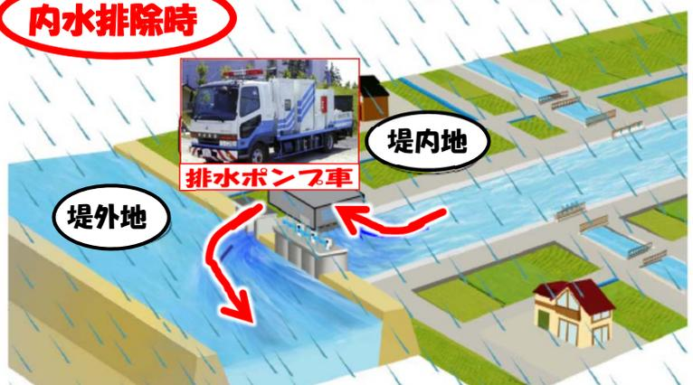
洪水時の内水被害を防止するため排水ポンプ車により排水を行います。
