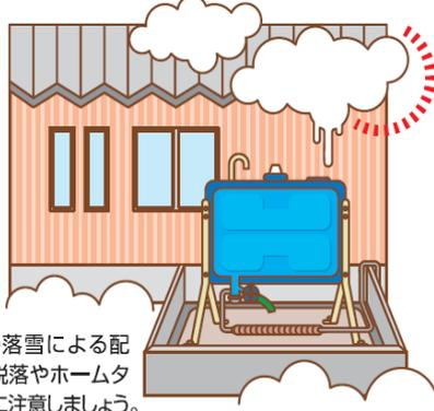
屋根からの落雪による配管の破損・脱落やホームタンクの転倒に注意しましょう。
