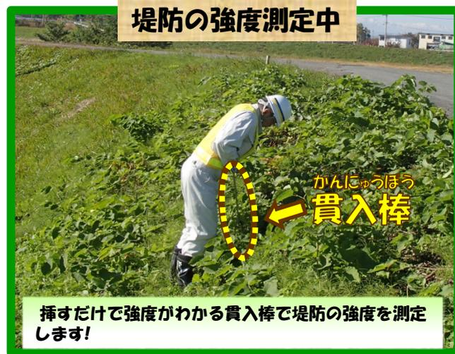
挿すだけで強度がわかる貫入棒で堤防の強度を測定します!
