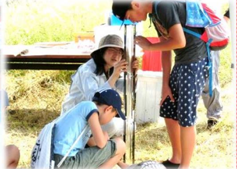
薬品が入ったチューブに川の水を入れ、反応結果と標準色を比較することでpH値などを調べます
