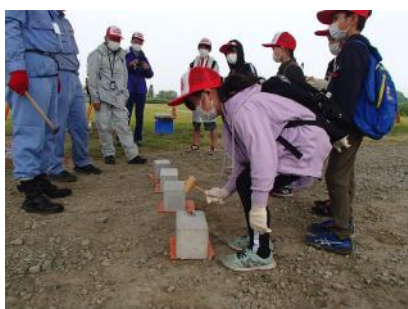
写真6-3 広報活動状況 (損傷供試体による打音確認)
