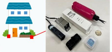
実証実験に用いている6種類の浸水センサ
