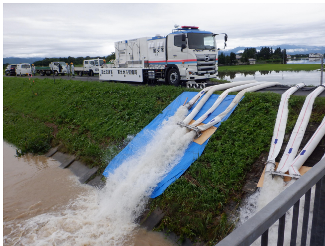
令和4年8月出水 南陽市鬼神川水門 排水ポンプ車 60m 3 /min × 1台
