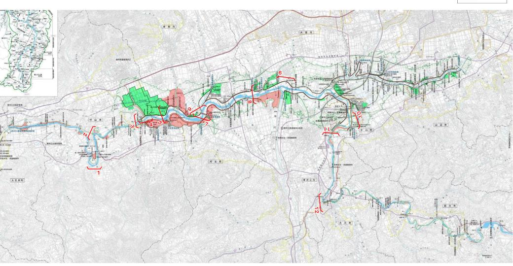
令和2年7月洪水 氾濫区域平面図及び斜め写真撮影位置図\_その2 上山市 南陽市 川西町 凡例 外水氾濫 内水氾濫 平山雨量観測所
